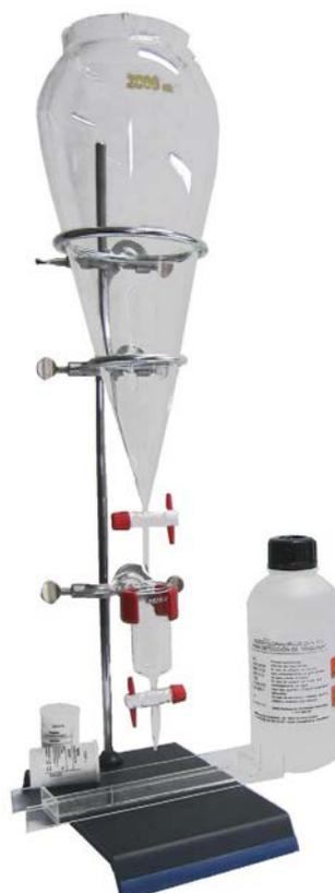
**IT-158 Digestor-Equipo** para detección de triquina
