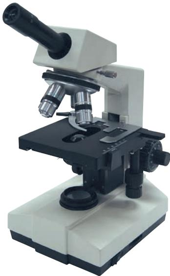
**IA-101** Microscopio monocular de 1.600X con luz halógena
