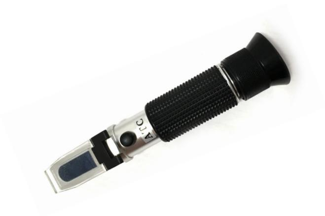
**IA-180** Refractómetro de mano clínico con compensación automática de temperatura
