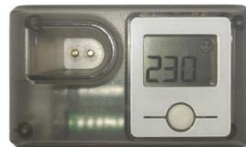
**IA-280T** Analizador de la pureza del agua "AQUATESTER"
