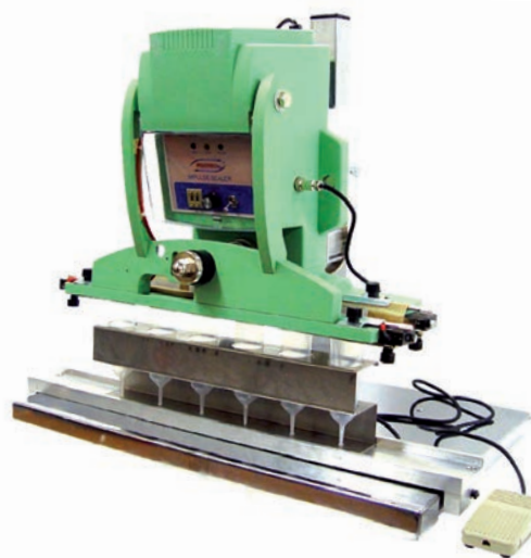
IA-281A Selladora automática para envasado de tubos
