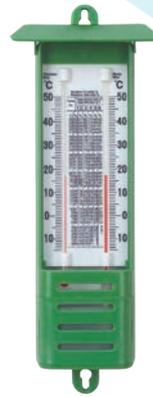
**DG-113F** Psicrómetro para medir humedad, de plástico
