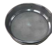
IT-159H Tamiz Inox 100 mm diámetro malla, 0,180 mm luz
