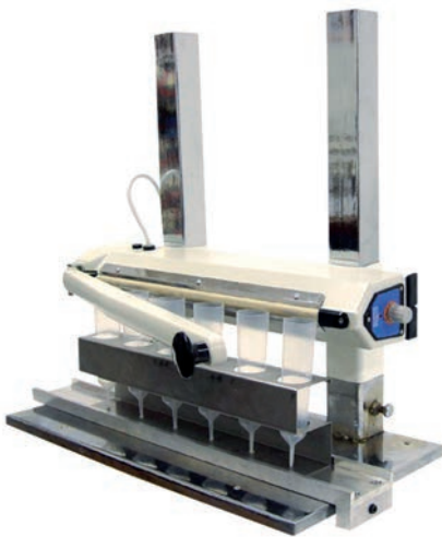
IA-281B Selladora manual para envasado de tubos
